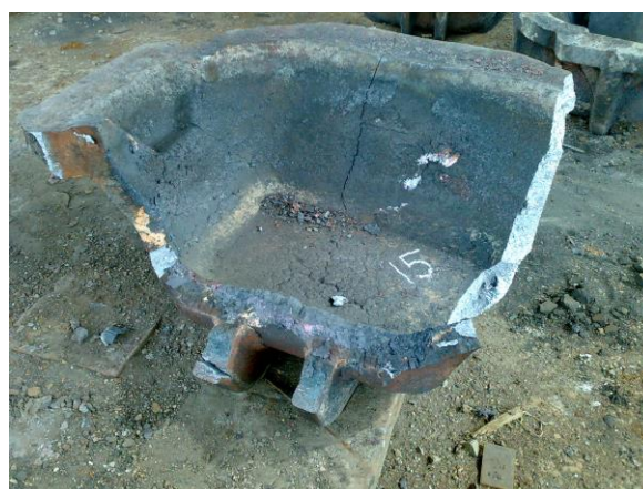
Рис. 6. Реальное разрушение изложницы
