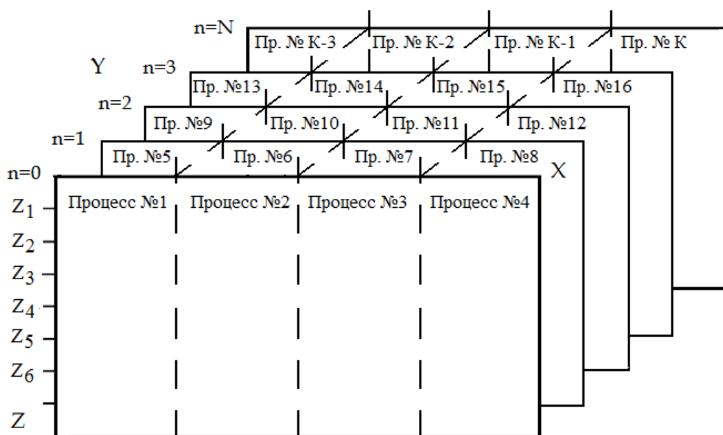
Рис. 1. Схема распределения расчётной области (n, x, z) по процессорам
