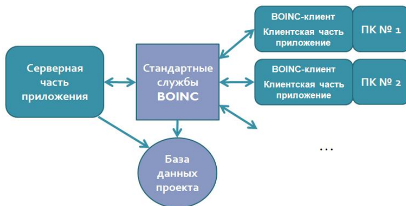
Рис. 3. Схема работы распределенного приложения в проекте SAT@home
