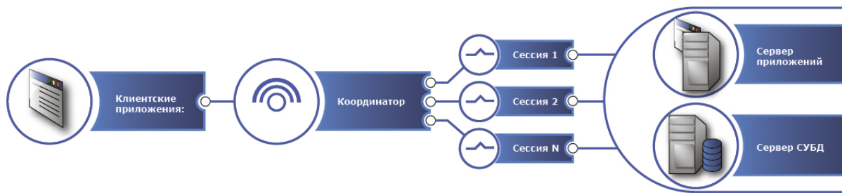
Рис. 3. Архитектура решения для реализации механизма параллельных вычислений средствами бизнес - логики
