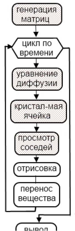
Рис. 1. Схема модулей алгоритма программы
