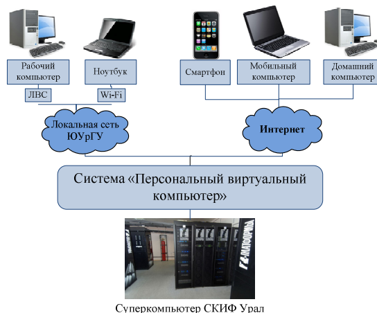
Рис. 1. Принцип работы системы «Персональный виртуальный компьютер».
