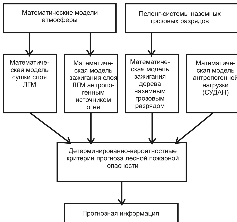
Рис. 1. Взаимосвязь математических моделей и отдельных сегментов системы прогноза лесной пожарной опасности
