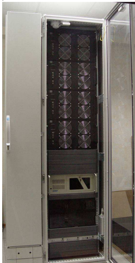
Рисунок 4 - Внешний вид реконфигурируемой вычислительной системы PBC-1P
