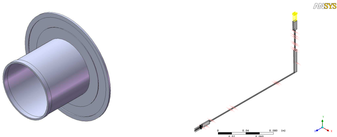
Рис. 14. Геометрия щели уравновешивающего устройства питательного насоса ПН 1500-350
