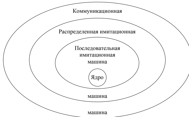
Рис. 1. Структура системы имитационного моделирования Мера
